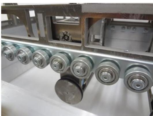
図 3-6 ロボットの後輪
